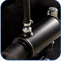
Heizsystem des Motors
