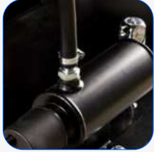
Système de préchauffage du moteur
