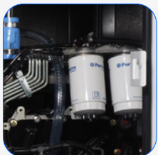
Filtre séparateur de particules de combustible
