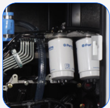
Filtro separador de partículas de combustível
