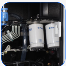
Filtro separador de partículas de combustível
