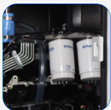
Filtro separador de partículas de combustível
