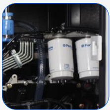
Filtro separador de partículas de combustible
