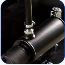
Sistema de caldeo de motor
