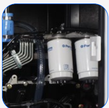
Filtro separador de partículas de combustible
