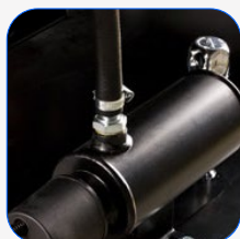
Sistema de caldeo de motor
