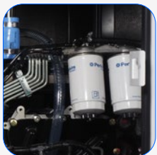
Filtro separador de partículas de combustible
