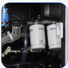
Filtro separador de partículas de combustible
