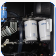
Filtro separador de partículas de combustible
